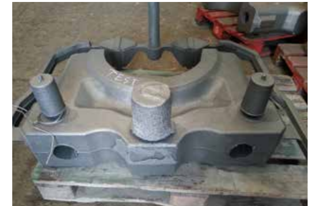
Gussteil mit Speiserresten vor dem Putzen
